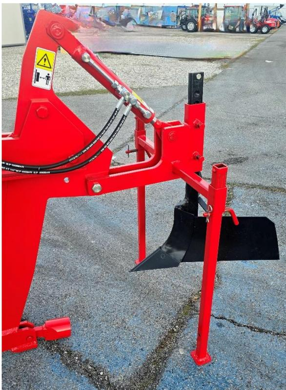
La punta singola mod. h 90 con disco e rullo idraulico F.lli Drigo ha una doppia funzione di decompattamento e drenaggio del terreno.
